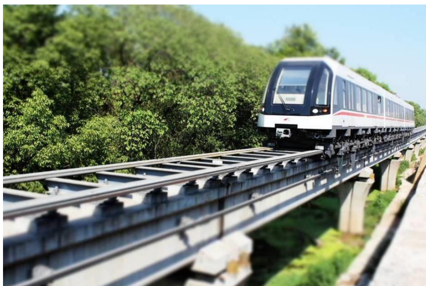
图 2.2.7-12 HSST 系统中低速磁浮列车与轨道示意图
