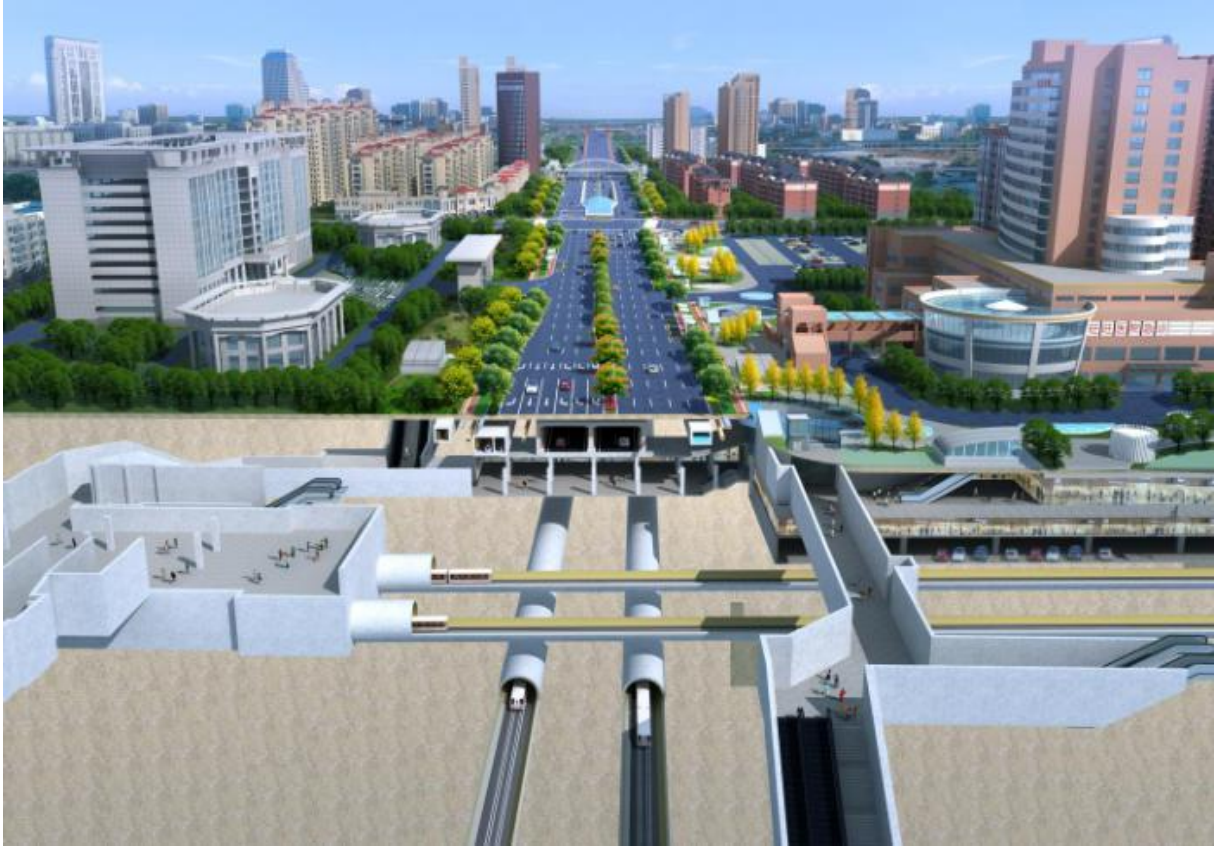
图 1-7 人民路隧道、地铁 5 号线、6 号线相交关系透视图
